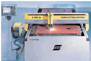
La familia de máquinas ESAB E-VENT está diseñada para obtener el máximo rendimiento en corte por plasma de chapa fina con la máxima precisión. La versión VX equipa cabezal rodante Plate Rider PLATE RIDER y la versión DX monta un cabezal flotante convencional. El diseño compacto y su avanzado sistema de guiado ofrecen un excelente comportamiento dinámico.
