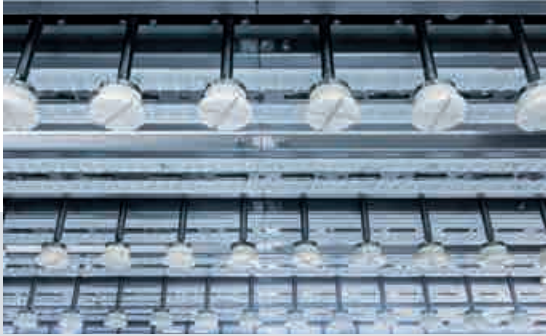
Espacios para aplicación homogénea de presión: entre las cintas de transporte magnéticas hay espacios para los cabezales neumáticos de separación de chapas.
